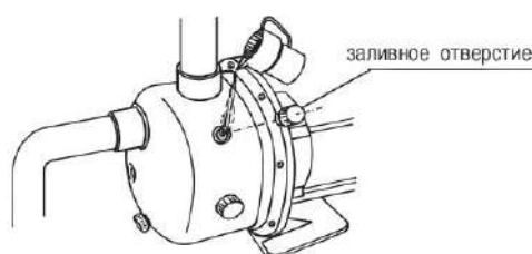
Рис. 6 Заполнение рабочей полости насоса жидкостью
