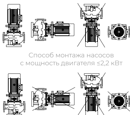
Способ монтажа положение насосов с мощностью двигателя > 2,2 кВт
